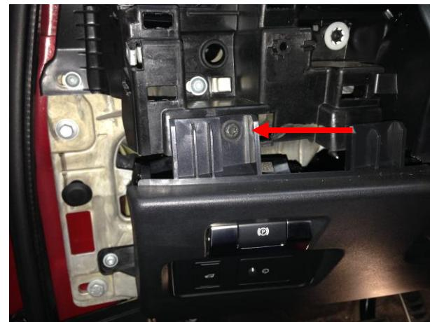
Выкрутить болт. Снять панель, отсоединить фишкы.
