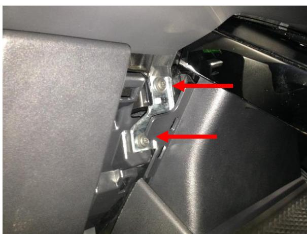
Выкрутить 2 болта, снять пластину.
