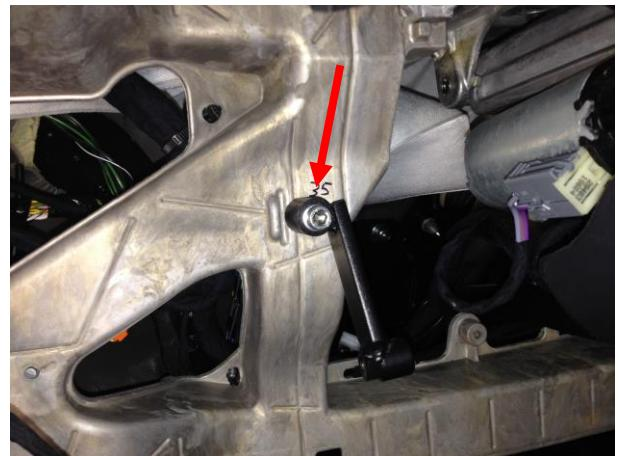
Установить верхнее крепление замка. Болт M6x35 заворачивать с небольшим усилием т.к. болт сам нарезает резьбу в данном отверстии.
